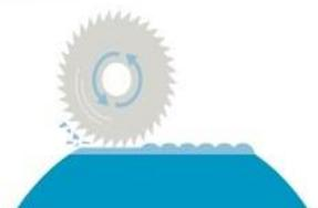
La fraiseuse rotative nivelle chacune des couches, délivrant des épaisseurs de couche jusqu'à 6 microns pour des géométries complexes et une répétabilité incomparables
